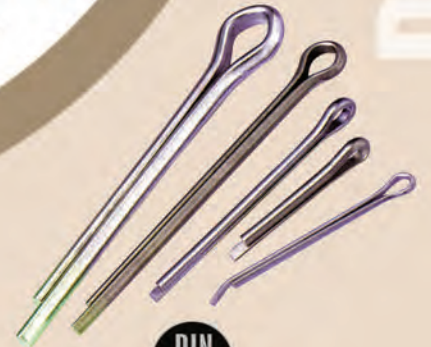
DIN 94 KOPİLYA | SPLIT PINS Anma adı | Thread size 1,5-2-2,5-3-3,5 4-5-6-7-8-10 Uzunluk (mm) Length 15-20-25-30-35 40-45-50-60-70 80-90-100-110-120
